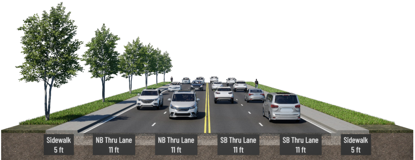
Figura 15. Condiciones Típicas del Derecho de Paso en Rainbow desde la Avenida 39 hasta la Avenida 47
