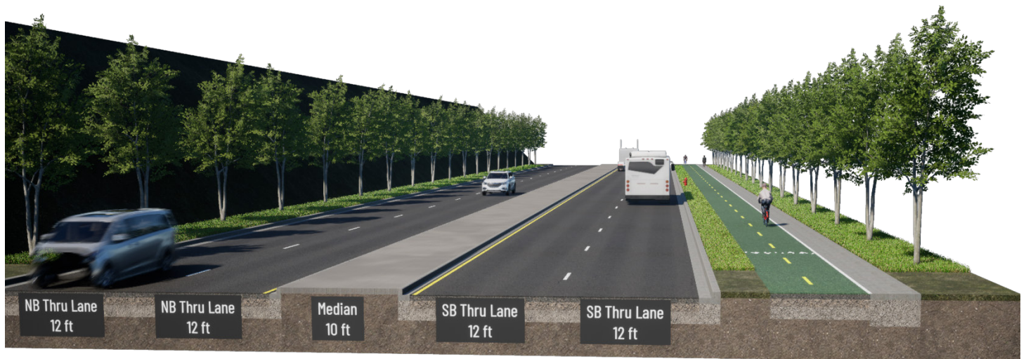
Figura 56. Un Camino Compartido Separado en Rainbow Entre Southwest Boulevard y Adams Street
