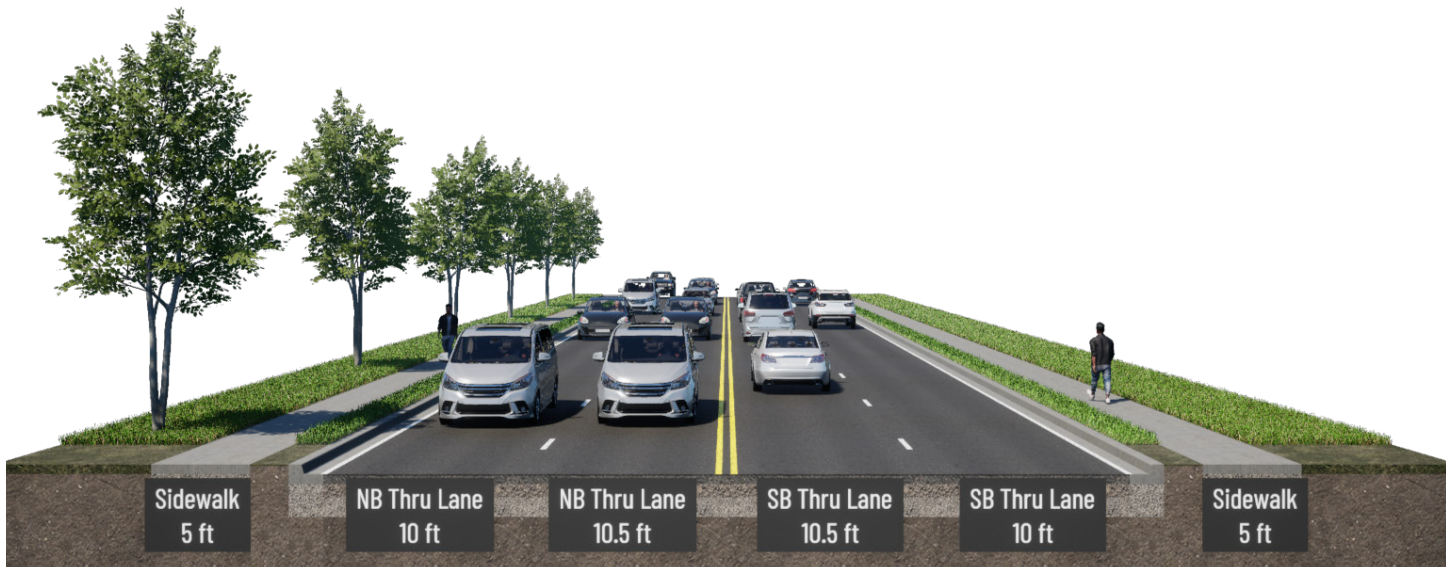
Figura 17. Condiciones Típicas del Derecho de Paso en Rainbow desde la Avenida 47 hasta Shawnee Mission Parkway
